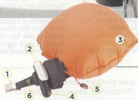
per azionare un **cuscino autogonfiante (3)**, che si apre in due secondi e che mantiene a galla per due giorni una persona di 130 chili. Dopo l'uso si può riutilizzare con grande facilità: basta ripiegare il cuscino e sostituire la **cartuccia di CO2 (4)**. Con un peso di 168 grammi e un volume 78 più piccolo di un giubbotto, Kingii wearable è la soluzione ideale per chi fa sport, dalla
